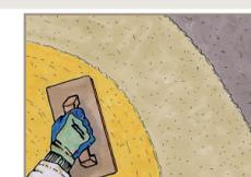
9 Sulla prima mano ripresa di Risanamur B-80 Evolution, procedere con la seconda mano per uno spessore totale mai inferiore a 1,5 cm., avendo cura di rifinire la superficie per il ricevimento della finitura superficiale.
