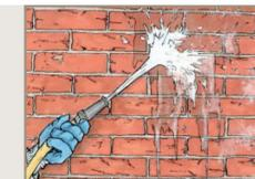
3 Rimozione di tutte le parti friabili e incoerenti tramite spazzolatura e lavaggio con getto d'acqua a pressione, al fine di asportare le parti mobili e sali residui in superficie.
