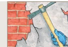
2 Demolizione accurata dell'intonaco ammalorato circa 1 mt sopra la parte degradata, rimozione dei materiali non compatibili.
