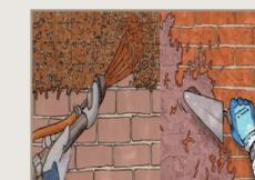
4 Dopo aver inumidito correttamente il supporto (per evitare la disidratazione dell'impasto) procedere con l'applicazione manuale o meccanica di Rinzaffo con spessore MAI inferiore ai 5 mm.
