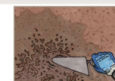
7 Se dopo 48 ore si dovessero constatare aree fortemente umide e bagnate (effetto rugiada superficiale) stendere un ulteriore strato di Rinzaffo solamente sopra l'area individuata.
