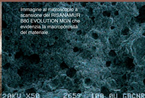
Immagine al microscopio a scansione del RISANAMUR B80 EVOLUTION MGN che evidenzia la macroporosità del materiale.
