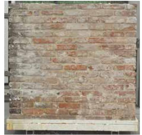
Figura 1: Muro 1 fronte A pannello murario allo stato grezzo, privo di intonaco, costruito a tre teste con malta di allettamento in calce e sabbia e mattoni fatti a mano (foto L. Scappin)
