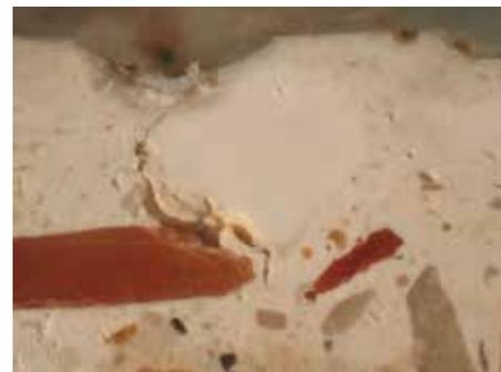
Figura 12: Micrografia al microscopio ottico polarizzatore di sezione sottile in luce trasmessa (immagine scattata a 40x con nicols incrociati), relativa al campione 17; l'aggregato è formato da frammenti spigolosi di calcare micritico riferibile a pietra d'Istria
