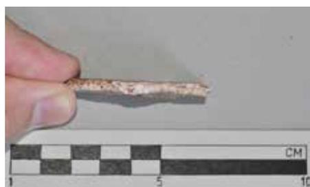
Figure 5a-b: Campione di intonaco in marmorino monoaggregato, di inizio XVII sec., che ad un riconoscimento autoptico può indicare la presenza di trattamenti superficiali conservati; lo spessore è intorno ai 5mm
