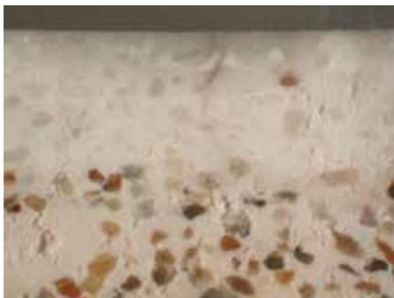
Figura 10: Micrografia al microscopio ottico polarizzatore di sezione lucida in luce riflessa (immagine scattata a 20x), relativa al campione 4; visibile strato a marmorino steso su intonaco a cocciopesto; evidente l'iso-orientamento dei granuli allungati
