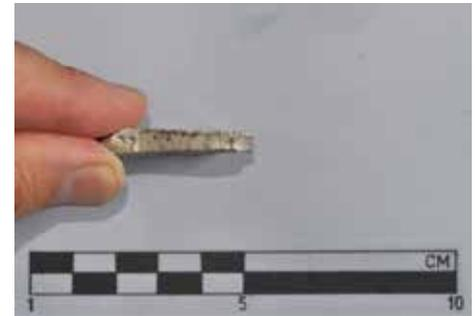
Figure 7a-b: Campione di intonaco in sabbia monoaggregato, di metà XVI sec., su cui si riconoscono striature da pennellatura di protettivo; lo spessore è intorno ai 5 mm
