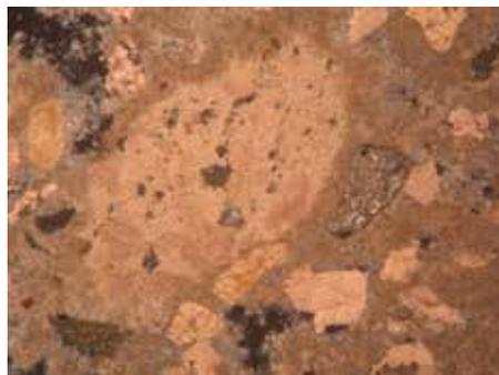
Figura 3: Micrografia al microscopio ottico polarizzatore di sezione sottile in luce trasmessa (immagine scattata a 40x con nicols incrociati), relativa al campione 16; intonaco bianco a sabbia in tre strati; in evidenza la preponderanza della matrice legante aerea; l'aggregato presenta nella maggior parte dei casi colori di interferenza elevati tipici di minerali carbonatici
