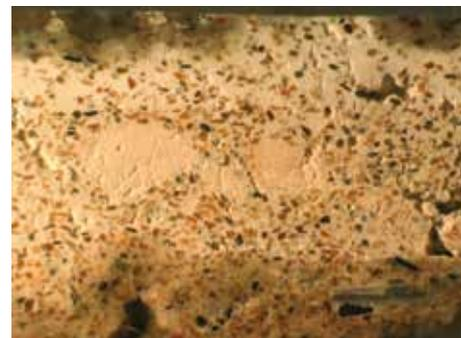
Figura 1: Micrografia al microscopio ottico polarizzatore di sezione sottile in luce trasmessa (immagine scattata a 120x con nicols paralleli), relativa al campione 10; particolare del punto di contatto tra due stesure successive di intonaco; visibile una discontinuità interstrato che porta ad ipotizzare che la seconda fase di stesura sia avvenuto "a secco", quando la carbonatazione della precedente era già spinta
